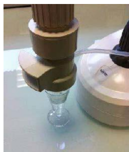
長時間モニタリング用 吸引アダプター
